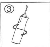
Faites pivoter le réservoir d'eau hors du fuselage et retirez-le
